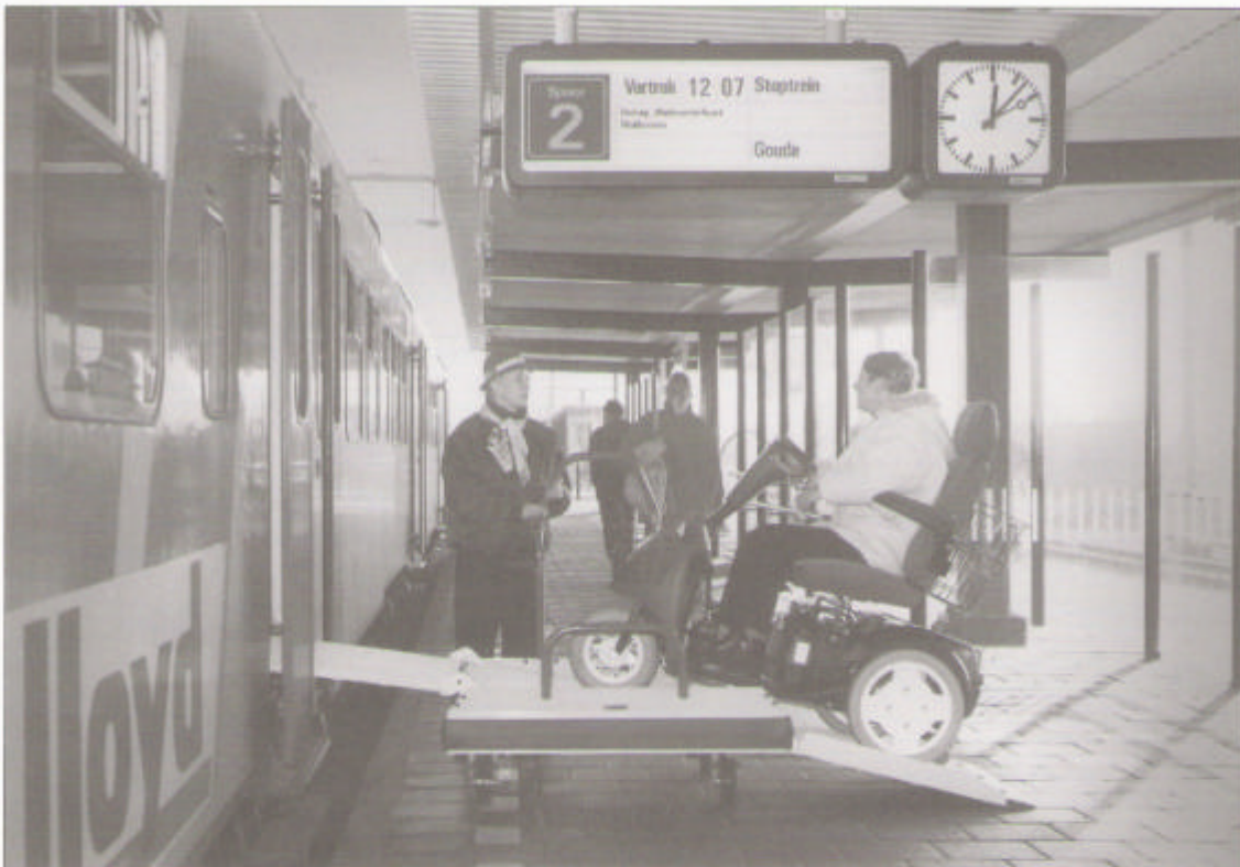
De overbrugging kan veilig genomen worden, kantelen van de rolstoel wordt tegengegaan door de zeer goede antislip-eigenschappen van het Stabag PcP veiligheidsprofiel type Oz.
